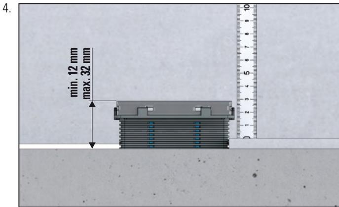
Bodenaufbau min. 12 mm / max. 32 mm
